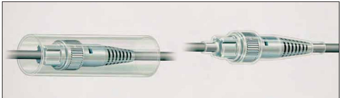
ZEUS Dual-Shrink™-Schläuche aus Fluorpolymer-PTFE/FEP bestehen aus einer äußeren Schicht aus PTFE-Schrumpfschlauch und einer inneren FEP-Schicht. Sie sind leicht anzuwenden und sorgen für eine enge, feuchtigkeitsbeständige Beschichtung von Drähten, Kabeln, Verbindern, Splices, Anschlussklemmen usw. Das PTFE schrumpft festschließend über den eingesetzten Teilen, sobald der bedeckte Teil erwärmt wird. Das FEP schmilzt und bildet eine feste oder fast
