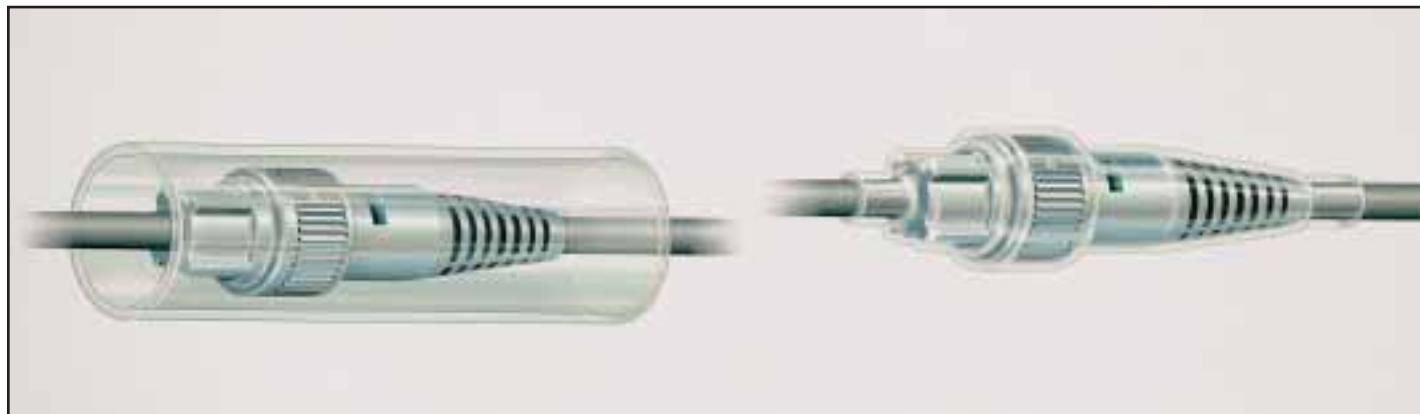
ZEUS Dual-Shrink™ 双层氟聚合物 PTFE/FEP 管由 PTFE 热缩外层和 FEP 内层构成。它应用方便，可与电线、电缆、连接器、接头、端子等紧密结合，具有防湿、防潮的作用。当被覆盖部分受热时，PTFE 会紧密地收缩在内嵌部件上，同时 FEP 熔化并流至一个固体或近似固体的封装件
