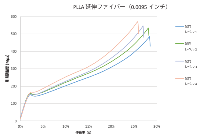
図 3: コントロールした配向と処理により、強度、硬さ、伸長などのカスタム化可能な機械特性を提供します。結節時のファイバーは、配向レベルを変えることにより、強度を最大化できます。
