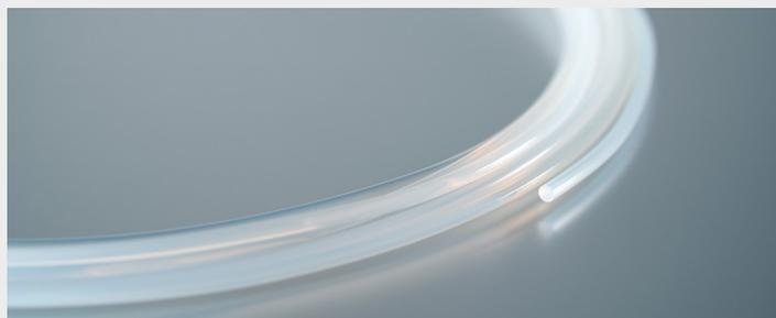
PTFE ガラス充填モノフィラメントは、マンドレルとして使用することができ、その高い圧縮強度のため、製造補助具として広く使用されています。
