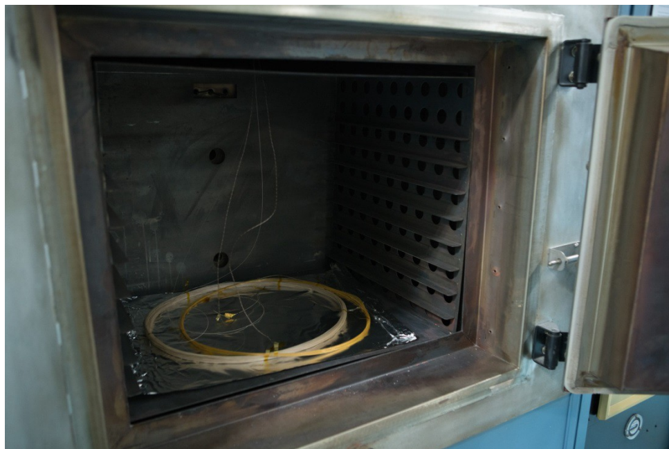
图 6: 高温热循环测试方案：光纤线圈在炉室中的放置状况。
