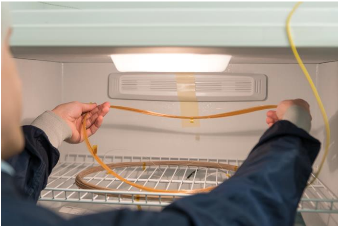
图 5: 零下（低温）热循环测试方案：光纤线圈在冷冻室中的放置状况。
