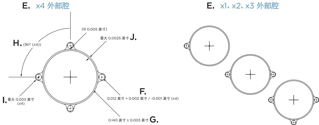
设计和生成 PTFE SUB-LITE-WALL® 超薄壁多腔管的规格指南：
